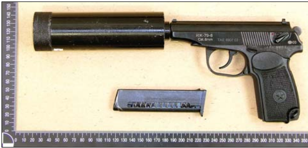
3 pav. Rusijos gamybos dujinis pistoletas IŽ-79-8, savadarbiu būdu perdirtas į kovinį pistoletą, pritaikytą šaudyti 7,65 mm kalibro Brauningo šoviniais, su savadarbiu garso slopintuvu
