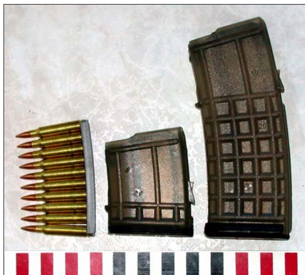
2 pav. Apkaba su dešimtimi 5,56 x 45 kalibro NATO standarto šovinių ir dvi dėtuvės, viena – dešimties, kita – trisdešimties šovinių talpos, skirtos šautuvui AUG-A2
