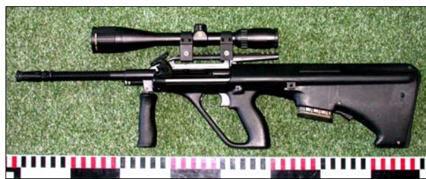
1 pav. 5,56 mm kalibro pusiau automatinis šautuvas AUG-A2 su optiniu taikikliu ir dešimties šovinių talpos dėtuve
